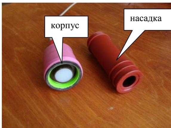
Рисунок 1. Корпус и насадка люксметра.
