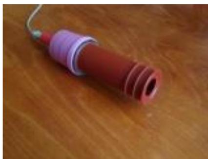
Рисунок 2. Люксметр с насадкой для измерения яркости.
